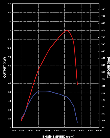
En el gráfico se muestran las características: curvas de potencia en rojo y de par en azul.
